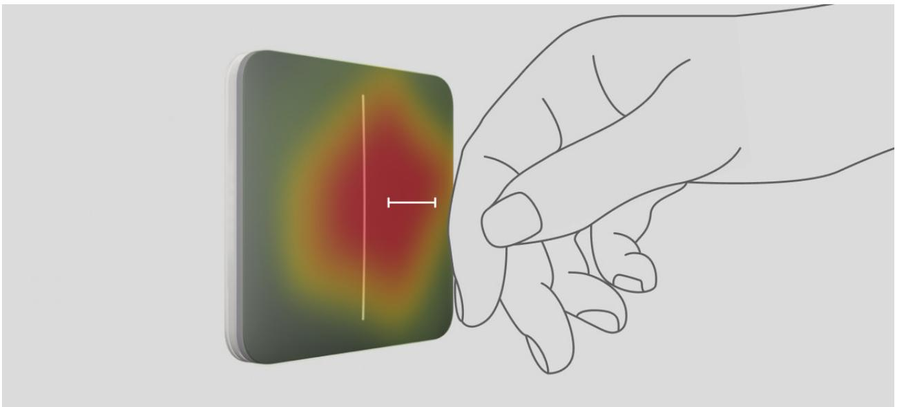
El LightSwitch permite controlar la iluminación al acercar una mano a una distancia de 15 milímetros del interruptor o al tocar el panel táctil del interruptor. El control sin contacto no limita la posibilidad de utilizar el dispositivo, incluso si los usuarios tienen las manos sucias o mojadas. El sensor reaccionará bajo cualquier condición. Por lo tanto, el interruptor se puede instalar en lugares donde hay mucha gente: restaurantes, fábricas y oficinas.
