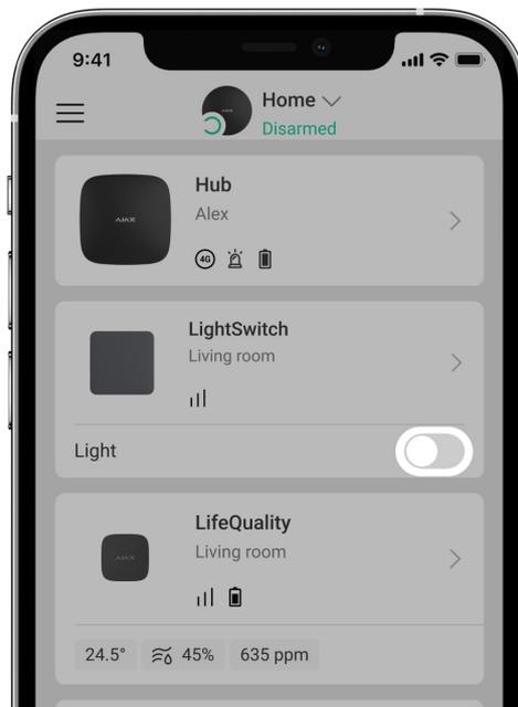
Haga clic en el interruptor en el campo **LightSwitch** en el menú **Dispositivos** en la app Ajax, y el estado de los contactos del interruptor cambiará al contrario. La iluminación se apagará o se encenderá. De esta manera, los usuarios del sistema pueden controlar la iluminación de forma remota. Por ejemplo, encender las luces en la estancia con antelación, antes de entrar.
