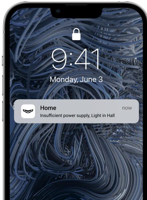
El LightSwitch comprueba continuamente los parámetros de su alimentación. Si el LightSwitch controla la potencia de un dispositivo de iluminación de potencia insuficiente (hasta 5 W), el sistema notificará a los usuarios del sistema Ajax. En este caso, es necesario reemplazar el dispositivo de iluminación por uno igual con mayor capacidad o conectar un condensador incluido en el kit en paralelo con el dispositivo de iluminación.
