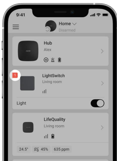
Cuando un dispositivo identifica un fallo de funcionamiento (por ejemplo, no hay conexión con el hub), la app Ajax muestra un contador de fallos de funcionamiento en el campo del dispositivo.
