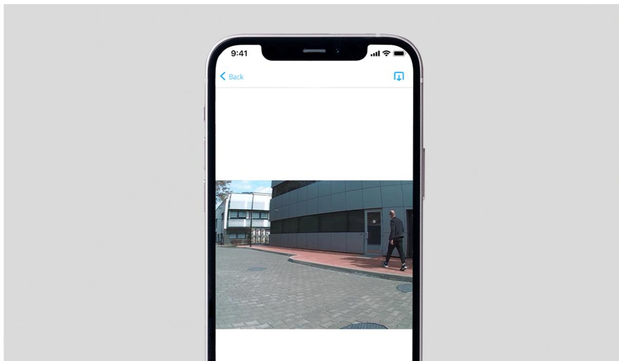
Cuando se activa el detector, la cámara MotionCam Outdoor integrada puede tomar de 1 a 5 imágenes con una resolución de  $320 \times 176$  y hasta 3 imágenes con una resolución de  $640 \times 352$  píxeles. El detector tiene iluminación infrarroja para tomar fotografías en la oscuridad, que se activa sólo cuando se provoca una alarma.
