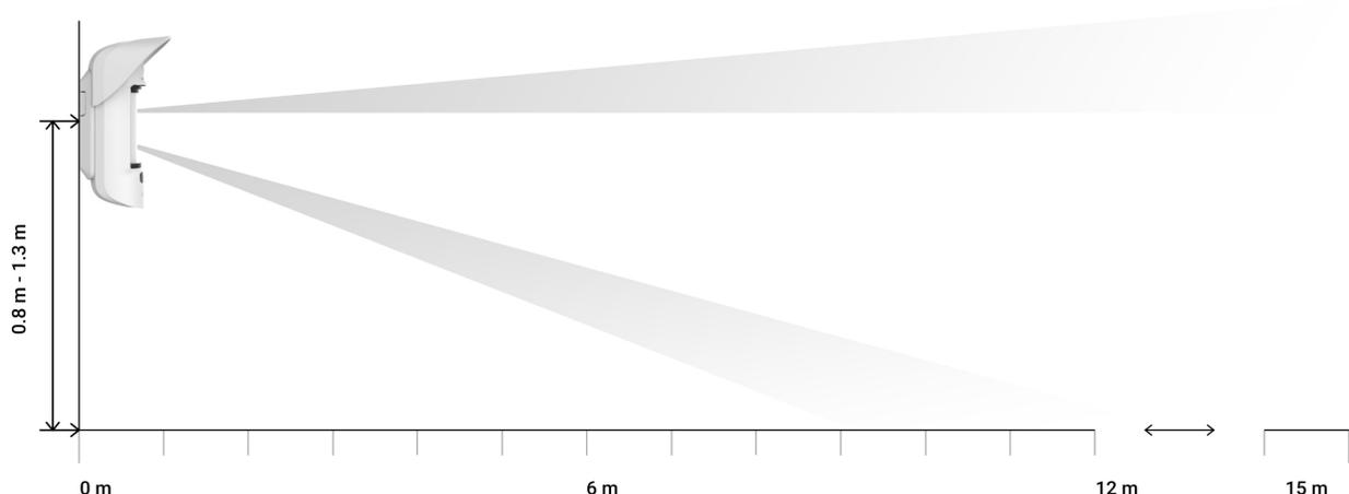
La distancia de detección se ajusta mediante la barra de desplazamiento **Distancia de detección (Detection Distance)** ubicada en el panel trasero del detector. Al elegir la ubicación de instalación, tenga en cuenta el rango máximo
