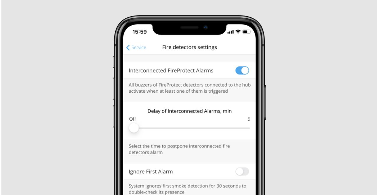
7. Si es necesario, active la opción **Ignorar primera alarma**. Esta configuración se recomienda para lugares con posibles fuentes de falsas alarmas. Por ejemplo, si el dispositivo está instalado en un lugar donde el polvo o el vapor pueden entrar en el detector.
