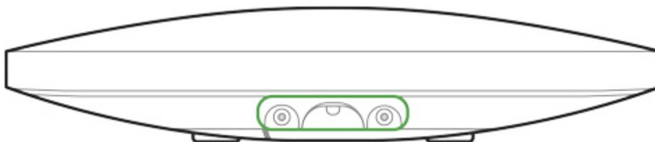
No voltee el ReX en fijación vertical (por ejemplo, en una pared). Con la fijación adecuada, el logotipo de Ajax se leerá horizontalmente.
